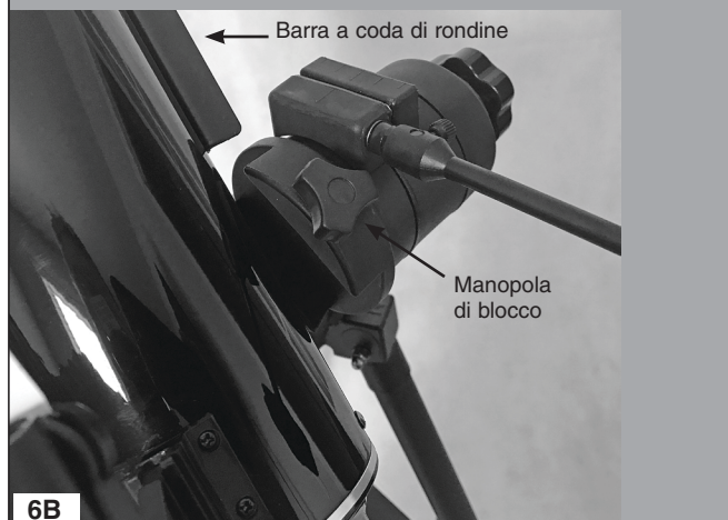
Figura 6. A) Slitta a coda di rondine B) Far scivolare la barra a coda di rondine sul tubo ottico nella slitta del braccio di montaggio, quindi stringere la manopola di blocco per fissare lo strumento alla montatura.
